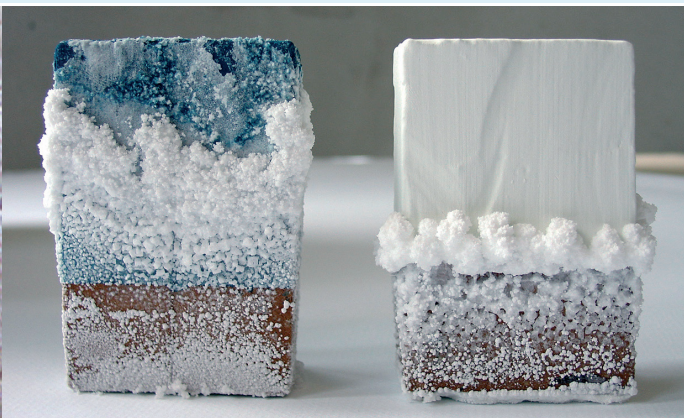
Uitbloeiingen als gevolg van wateroplosbare zouten in bakstenen
